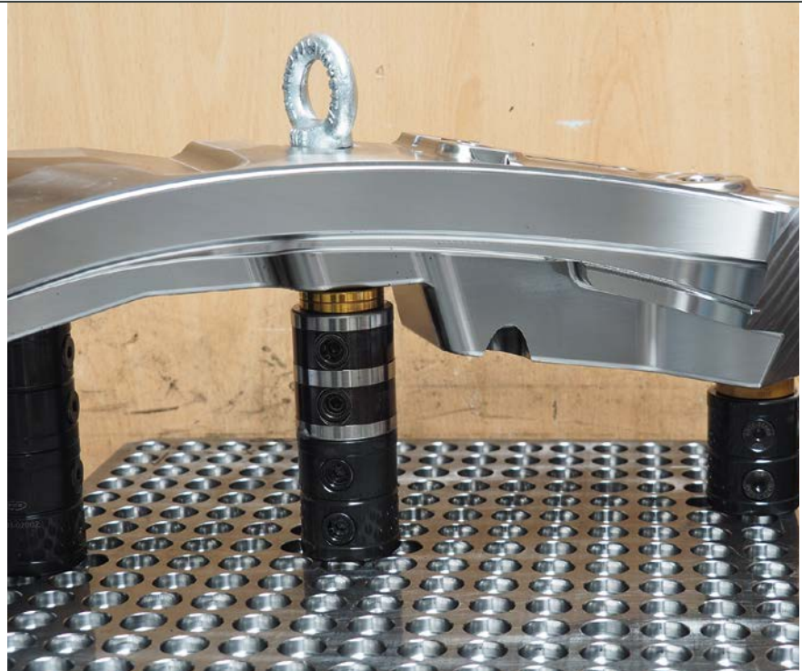
Spannen für Fortgeschrittene: Mit dem FCS-System lassen sich auch komplexe Geometrien im Raum definiert spannen. (© Hanser/Schröder)
